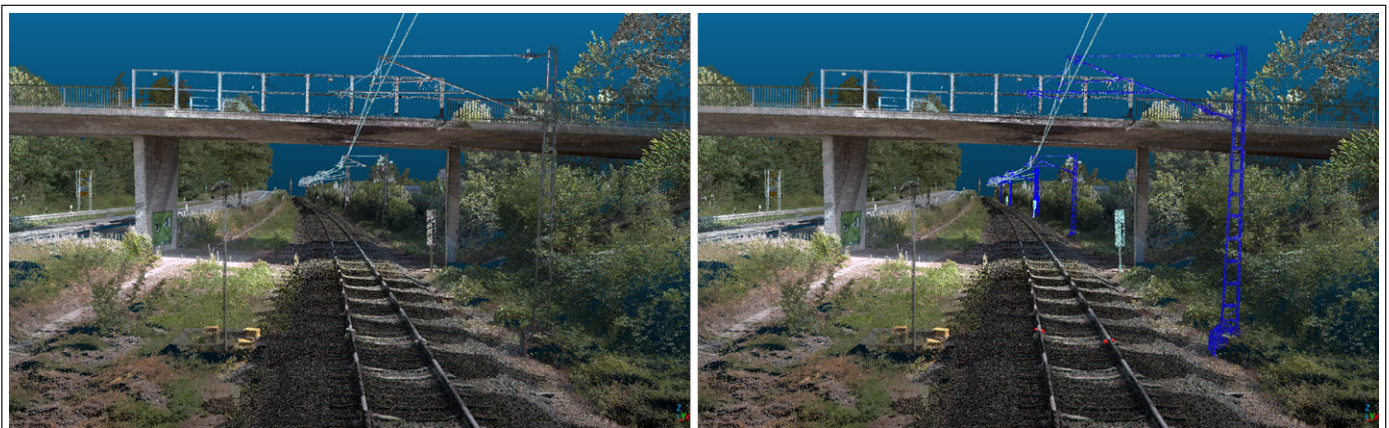
Abb. 1: Tiefe neuronale Netze beschleunigen das Auffinden von Objekten in 3D-Punktwolken. Beispiel einer Punktwolke: Oberleitungs Masten (blau), Vorsignalbake / Ne3 (hellblau), Achszähler (rot)
